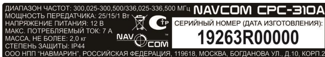
Рисунок 2 – Внешний вид этикетки радиостанции CPC-310A
