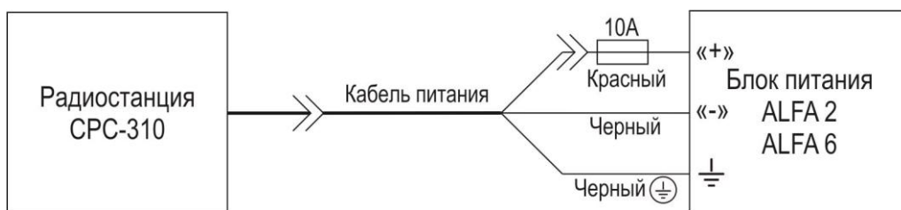
Рисунок А.1 – Схема подключения радиостанции к блоку питания
